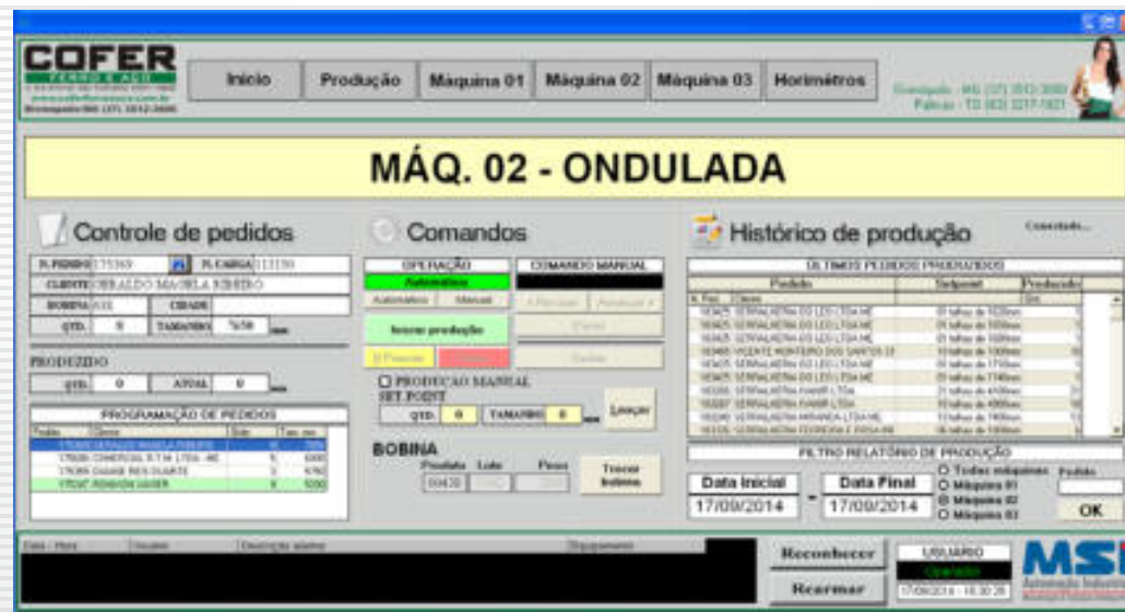
Figura 10 - Software para máquinas de telha (Supervisor desenvolvimento interno, CLP Schneider)
