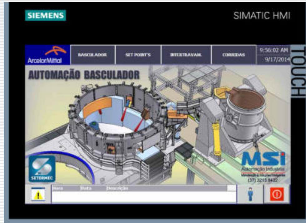
Figura 9 - Basculador de Gusa PLC Siemens IHM Siemens
